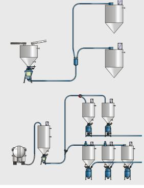
Насосы для транспортировки в плотной фазе предназначены для использования в различных отраслях в зависимости от материалов и расстояния транспортировки. Линейка насосов включает:
