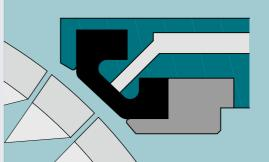
Уплотнение автоматически надувается только после полного закрытия клапана.
