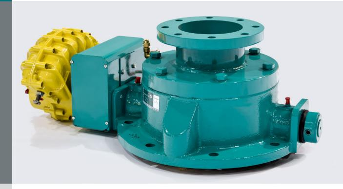
При открытии и закрытии происходит автоматическое надувание уплотнения, что позволяет исключить вероятность контакта с куполом и избежать чрезмерного износа.
