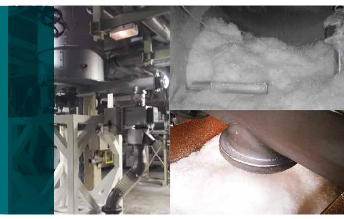
Los materiales difíciles de dosificar, como las hojuelas de PET, las fibras de vidrio y la molienda, se manejan fácilmente con el dosificador Simplex.
