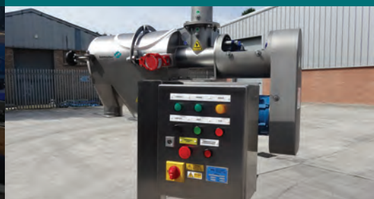
Tamizadora con el panel de control integral Kek K300C
