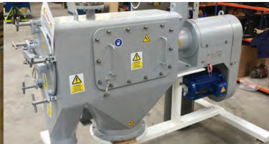
Tamizadora de presión en línea con puerta lateral con cerrojo Kek K650CP
