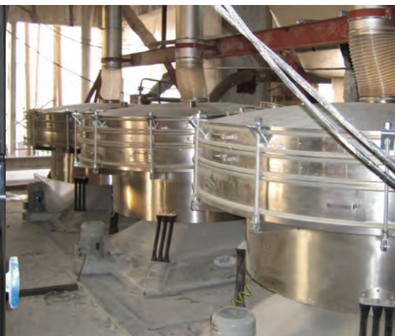
Cribadora de tambor de plataforma GKM KTS 2400 2
