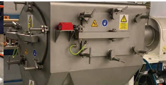
Tamizadora de presión mostrando abrazaderas de puerta con bisagras de alta resistencia Kek K650CP
