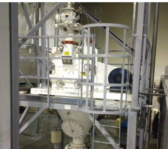
Sistema de molienda de azúcar de bucle cerrado Kek
