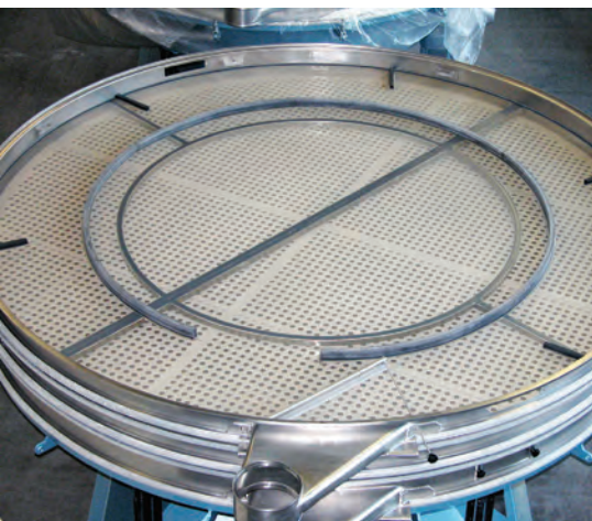
Vista de cribadoras de tambor, plataforma de tamiz
