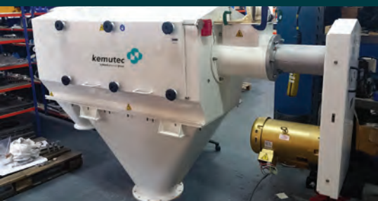
Tamizadora para el procesamiento continuo de alta capacidad Kek K1350
