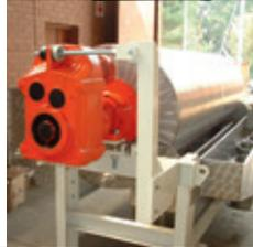
**Trommelmagnetabscheider für Nassverfahren**
