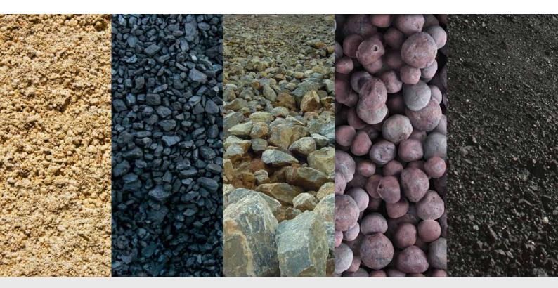
Die umfangreiche Materialdatenbank von Schenck Process beinhaltet etwa 10.000 Proben, bei denen Eigenschaften wie Partikelgröße, Streuverhalten, Form, Porosität, Schüttdichte, Temperatur, Feuchtigkeitsgehalt, Brüchigkeit und Luftretention sorgfältig gemessen wurden, um die geeignete Fördermethode zu ermitteln.
