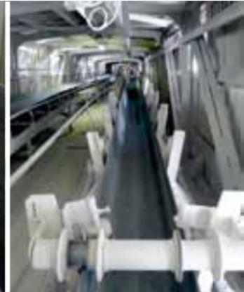
U-Förderer stehen herkömmlichen Rollgurtförderern in nichts nach. Sie bestechen jedoch durch die deutlich höheren Fördermengen. Möglich werden diese durch die kleine, selbsttragende Stahlkonstruktion mit sehr geringem Eigengewicht, die zudem noch platzsparend ist.
